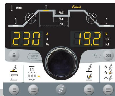
Пользовательский интерфейс с двумя дисплеями и поворотной кнопкой для быстрой настройки параметров
