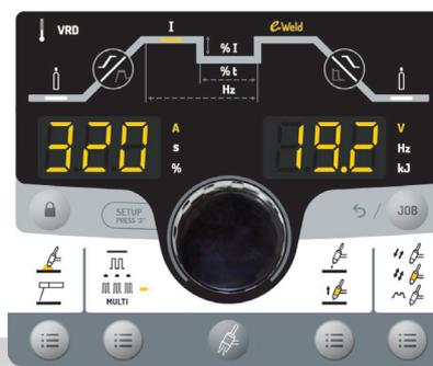
Пользовательский интерфейс с двумя дисплеями, поворотной ручкой и кнопкой для быстрой настройки параметров
